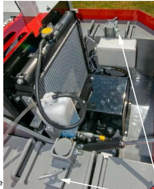
Abbildung 5.13 | Ballastplatten sichern – Prins Sprinter
